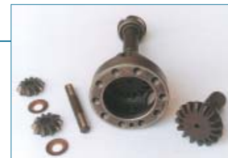
Detalle del despiece del interior de una caja de cambios de un automóvil, en el que pueden apreciarse engranajes de distintos tipos y formas. (GENTILEZA: CENTRO DE FORMACIÓN DE RENUALT ARGENTINA)
