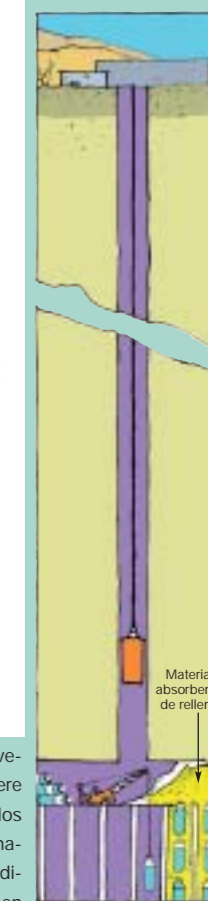
La construcción se realizó a 600 m de profundidad en una formación geológica seca y estable.
