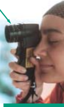
Fotómetro, instrumento para medir la intensidad de la luz.
